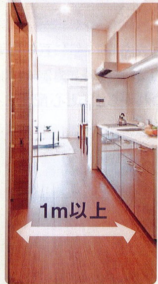
廊下幅 1m・バリアフリー
